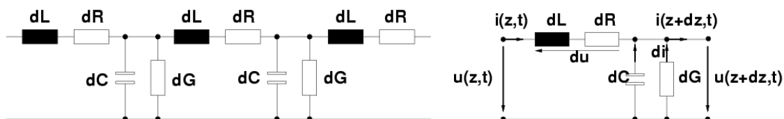
Abbildung 1: Links: Ersatzschaltbild für Leitungen. Rechts: Differentielles Leitungsstück.
